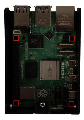
Fixez maintenant les dissipateurs thermiques fournis à votre Raspberry Pi. Pour ce faire, retirez le film adhésif des tampons thermiques et placez les dissipateurs thermiques dans la position suivante :
