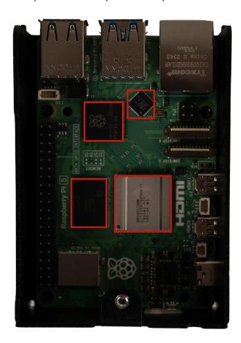
Vous pouvez maintenant connecter le refroidisseur actif installé dans le boîtier en standard ou simplement le retirer du boîtier. Si vous souhaitez utiliser le ventilateur, connectez le câble du ventilateur à la connexion du ventilateur indiquée ci-dessous sur votre Raspberry Pi 5 :
