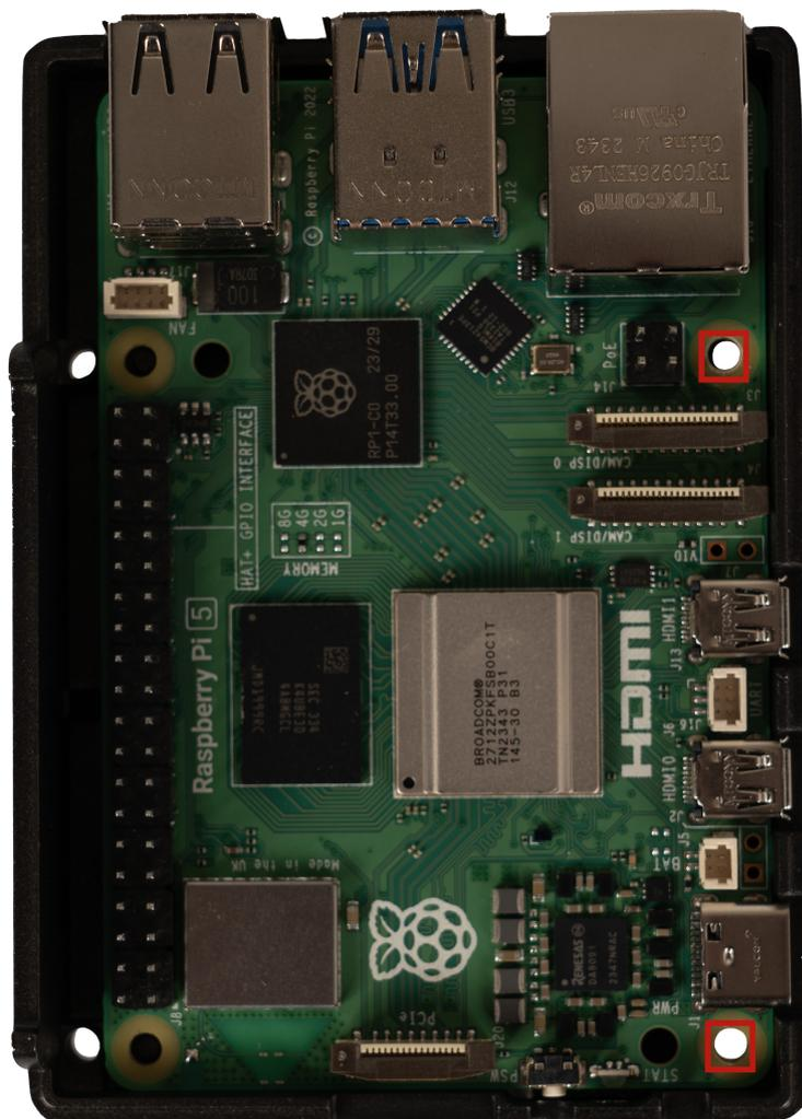
Fixez maintenant les patins thermiques fournis sur la partie supérieure du boîtier. Pour ce faire, retirez la pellicule adhésive des tampons thermiques et placez les tampons thermiques dans les positions suivantes :
